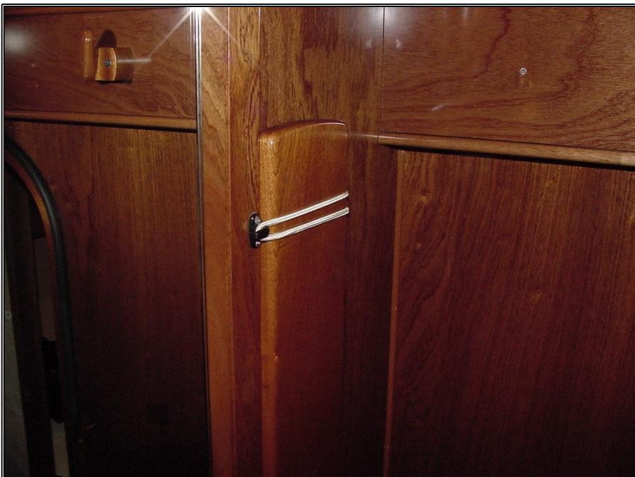
*Figure 104 – Rangement de la barre anti-roulis de la cabine arrière (version coiffeuse)*
