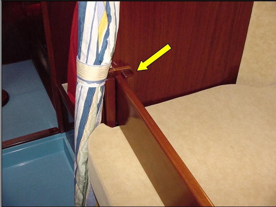
*Figure 103 – Barre anti-roulis de la coursive mise en place*
