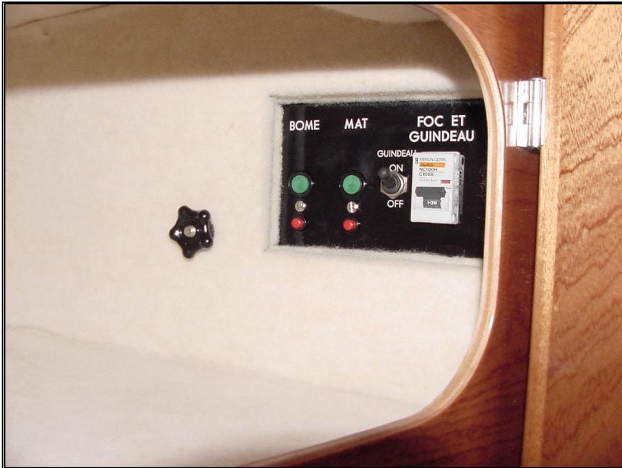
Figure 107 – Interrupteur de sécurité du guindeau
