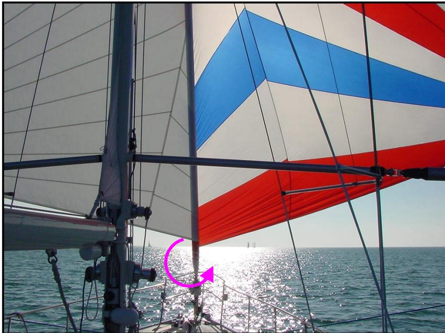
Figure 46 – Enroulement simultané du foc et du ballooner
