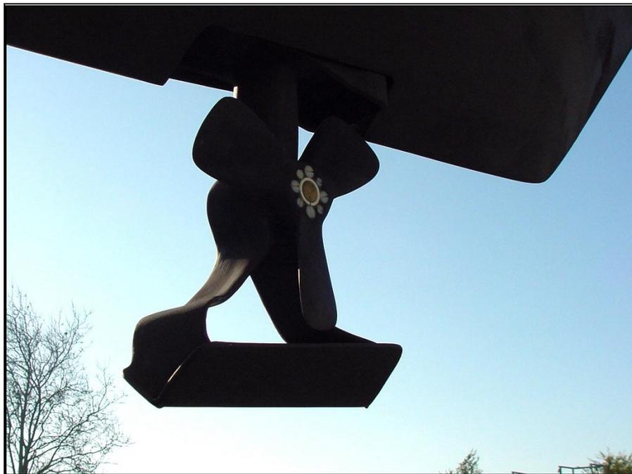
Figure 12 – Propulseur d'étrave
