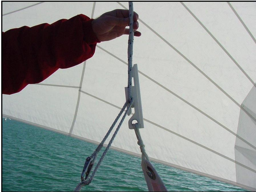
*Figure 44 – Crochet en plastique avec drisse de ballooner*
