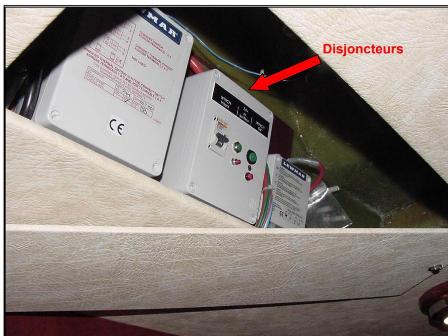
Figure 21 – Trappe d'accès aux disjoncteurs de winches tribord et grand'voile
