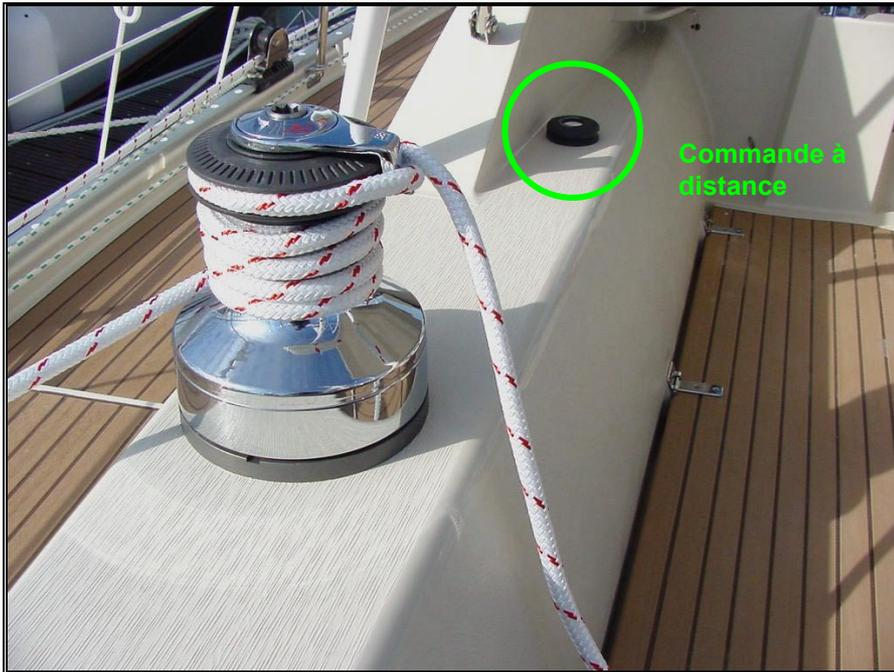
Figure 18 – Winch électrique d'écoute de foc
