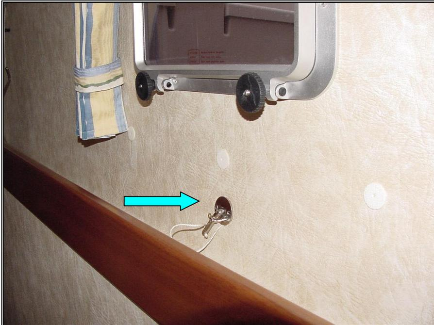
*Figure 62 – Blocage de l'ouverture du compartiment moteur*
