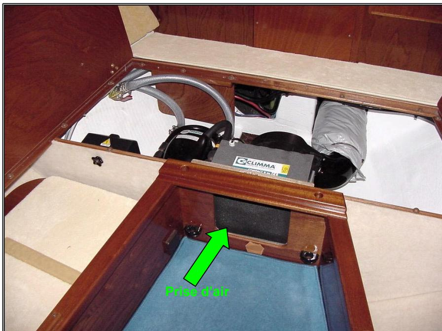
Figure 90 – Climatisation de la cabine avant
