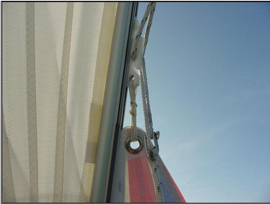
*Figure 45 – Crochet engagé dans le tube de foc*
