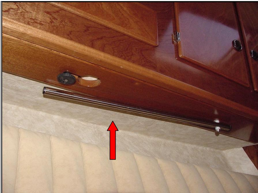
*Figure 100 – Rangement de la barre anti-roulis de la cabine avant*
