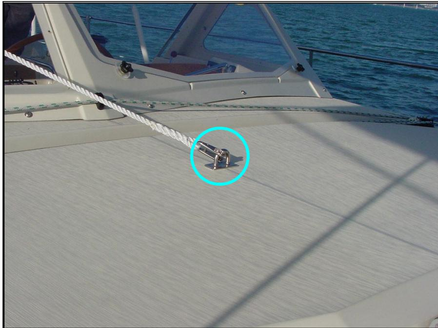
*Figure 49 – Fixation de l'amure du ballooner d'artimon*
