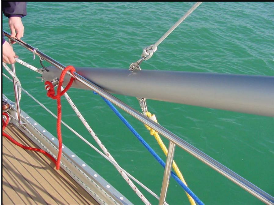
*Figure 40 – Fixation des bouts sur le tangon et passage de l'écoute de foc*
