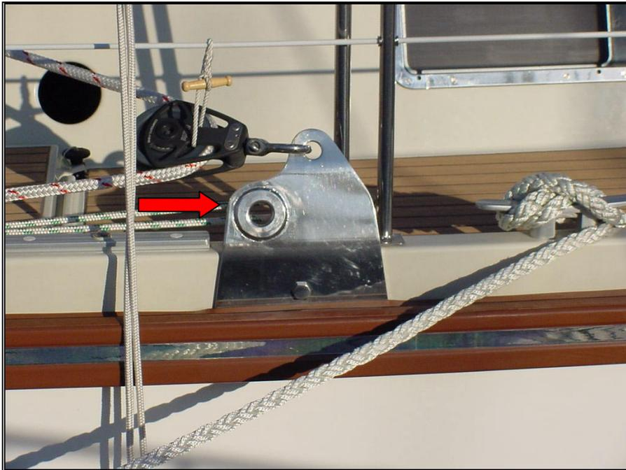
Figure 129 – Cadène de levage arrière
