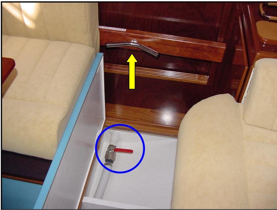
*Figure 52 – Barre de bois d'étanchéité mise en place et vanne de fermeture de la douche avant (photographiée fermée)*
