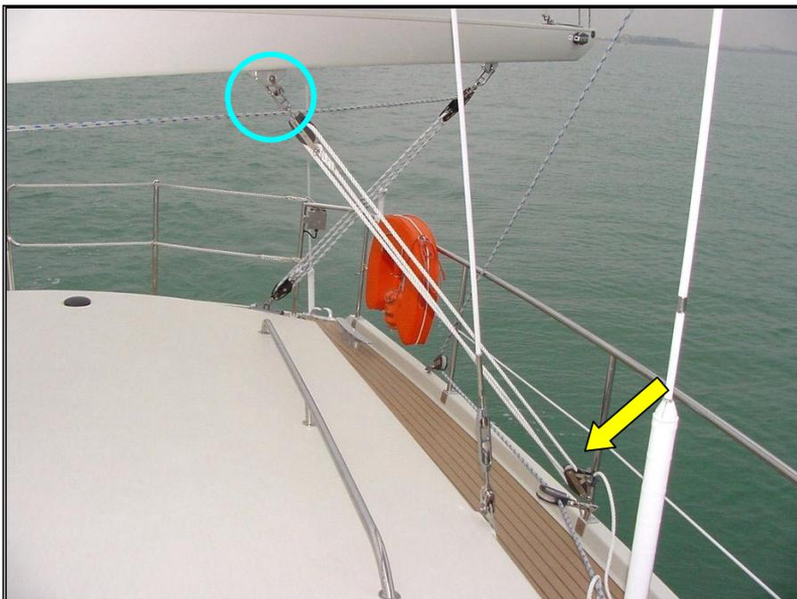
Figure 33 – Palan de retenue de bôme du mât d'artimon
