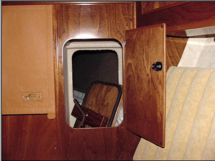
*Figure 110 – Trappe étanche du puits à chaîne*
