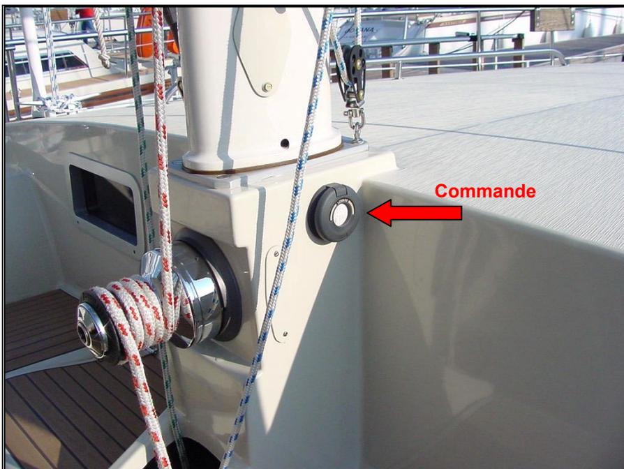
Figure 19 – Winch électrique d'écoute de grand'voile
