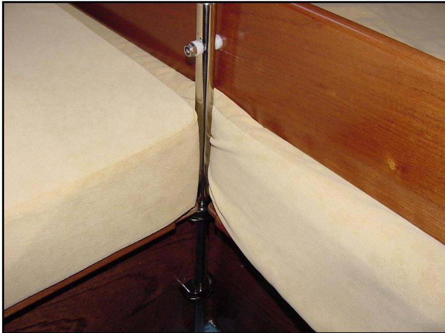
*Figure 105 – Barre anti-roulis de la cabine arrière mise en place (version coiffeuse)*
