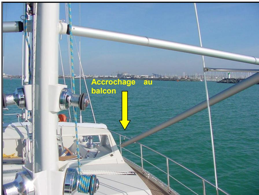
Figure 39 – Tangon assemblé au tangonnet et accroché au balcon
